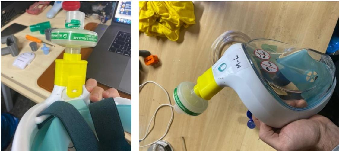
FIG. 10 PIEZA ADAPTADORA PARA FILTRO EPI
